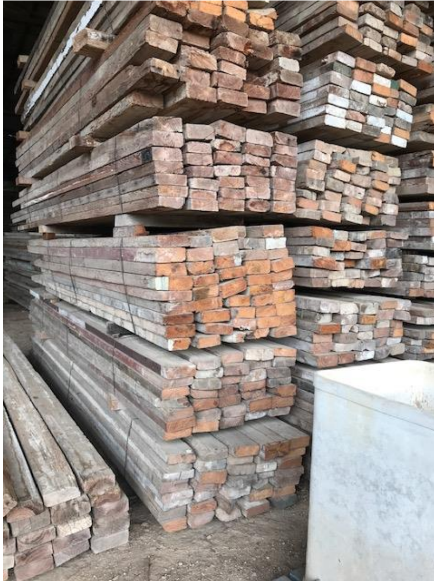
Imagen 6. Vigas de derribo para seleccionar para el proyecto.
