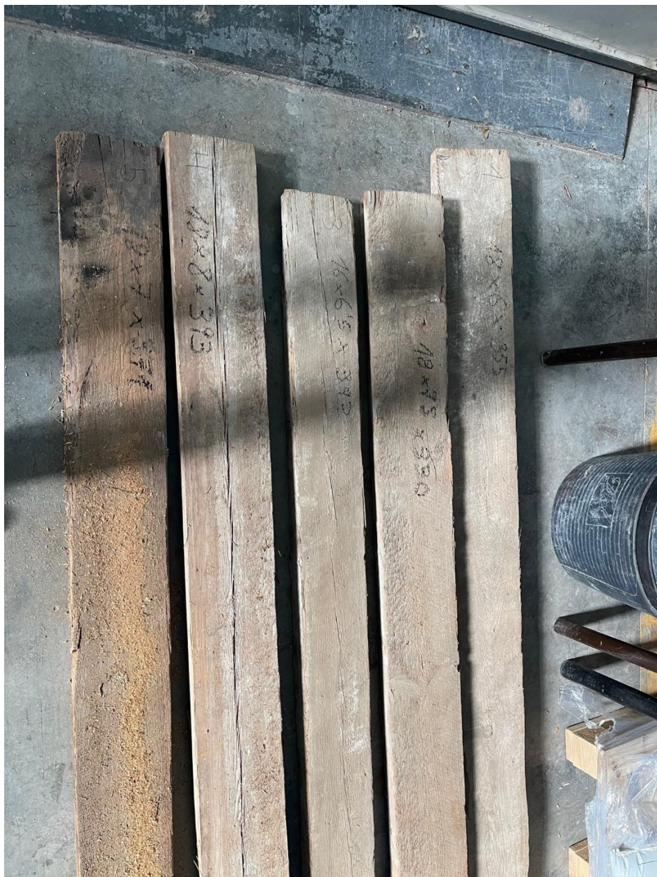
Imagen 11. Medición de las vigas seleccionadas para los ensayos destructivos.
