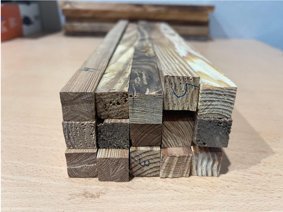
Imagen 18. Probetas obtenidas del extremo de las vigas 1-5.
