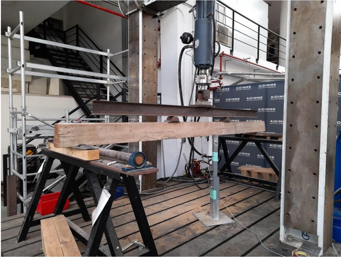
Imagen 13. Ensayo de rotura a flexión (MOR) y medición del MOE de la viga 1.
