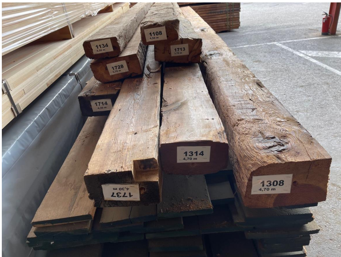
Imagen 4. Vigas de derribo preparadas para su clasificación y reutilización.
