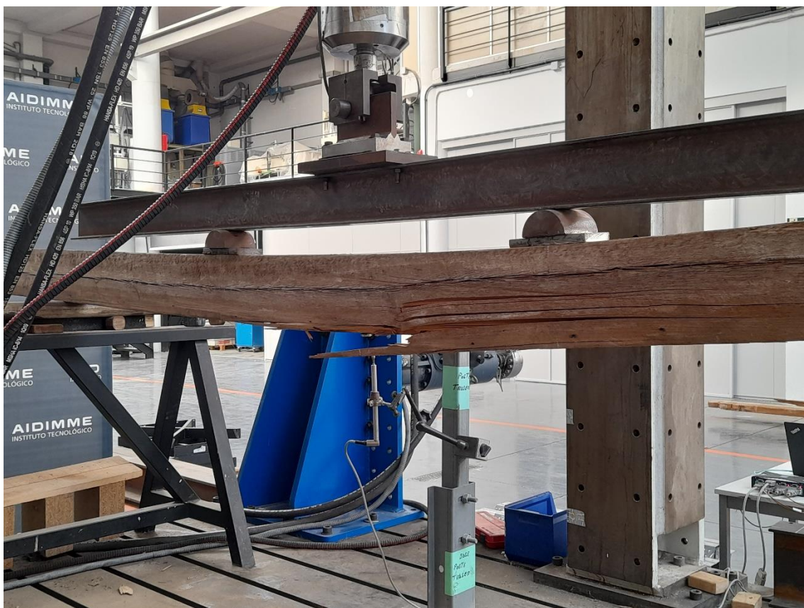
Imagen 16. Viga 4 rota tras el ensayo.
