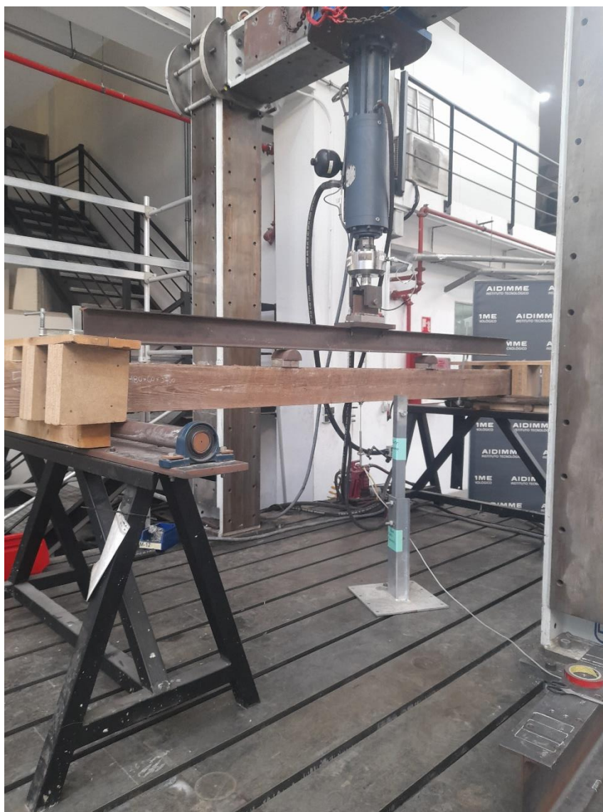
Imagen 17. Viga 5 durante el ensayo.
