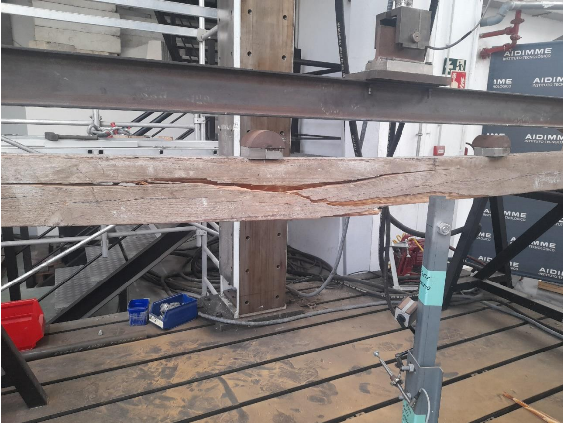
Imagen 15. Viga 3 rota tras el ensayo.
