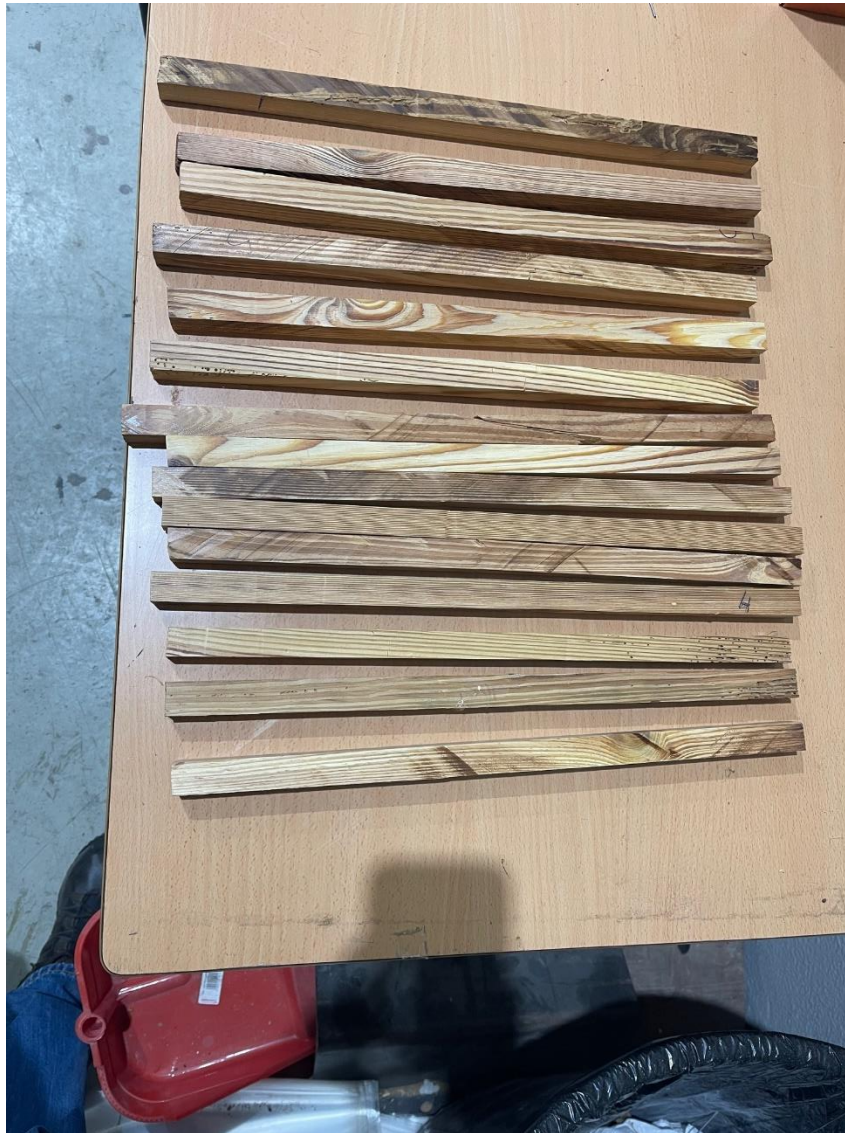
Imagen 19. Probetas obtenidas del extremo de las vigas 1-5.
