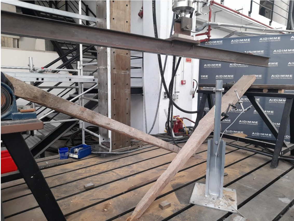
Imagen 14. Viga 2 rota tras en ensayo.
